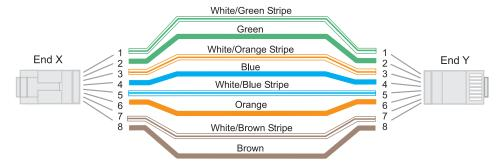
FIG. 29 RJ-45 connections per T568A
