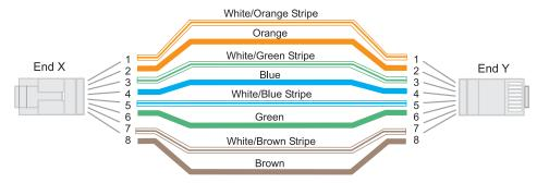
FIG. 30 RJ-45 connections per T568B
